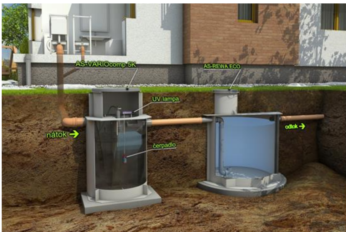
Obr. 13 Příklad domovní ČOV s akumulací vyčištěné vody
